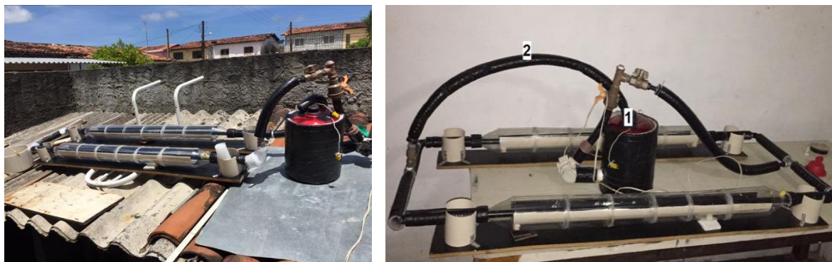
Figura 10: (a) Arranjo em série. (b) Arranjo em paralelo. Fonte: elaborado pelo autor.
