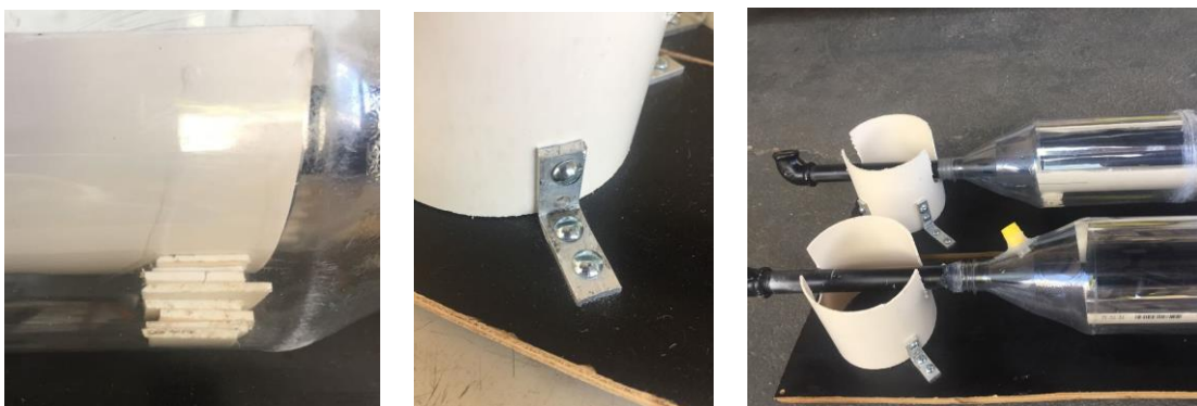
Figura 7: (a) Elevação em PVC. (b) Fixação da base. (c) Montagem. Fonte: elaborado pelo autor.
