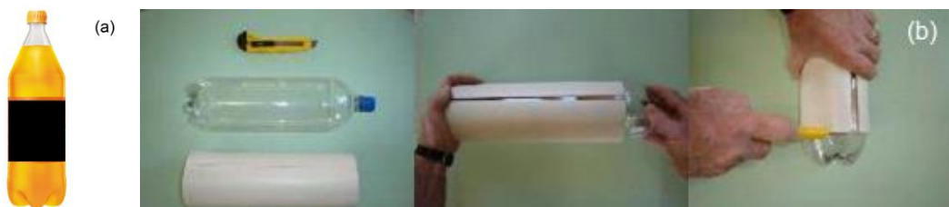
Figura 3: (a) Modelo de garrafa PET utilizada. (b) Processo de corte. Fonte: (a) Adaptado de Extra (2018); (b) Acervo do Autor (2017)
