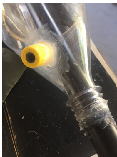
Figura 9: Válvula de vácuo em um dos coletores. Fonte: elaborado pelo autor.
