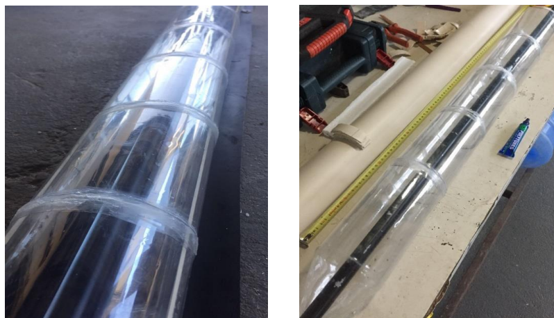
Figura 4: (a) Colagem das garrafas PET. (b) Montagem das tubulações. Fonte: elaborado pelo autor.
