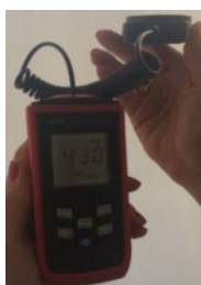
Figura 12: Luxímetro medindo 430 lux na medição do ponto P1 da Figura 15. Fonte: Elaborado pelos autores, 2016.
