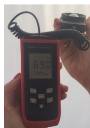
Figura 13: Luxímetro medindo 690 lux na medição do ponto r3 e r6 da Figura 15. Fonte: Elaborado pelos autores, 2016.
