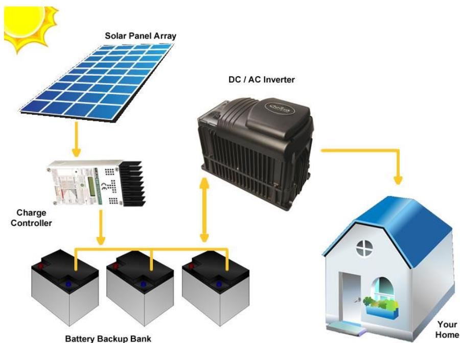
Figura 3: Esquema fotovoltaico off grid. Fonte: <http://www.solarbrasil.com.br>.
