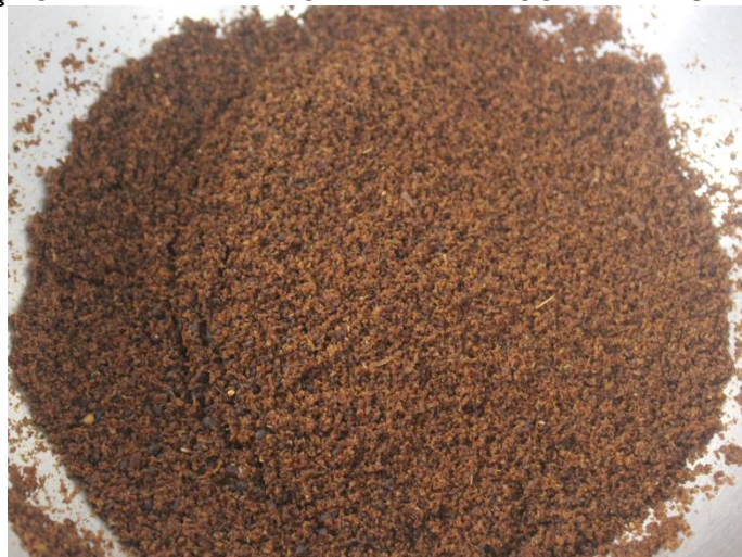
FIGURA 6 - COMPOSTO FASTCOMPOST DA BROOKS AMBIENTAL® APÓS PROCESSO DE TRITURAÇÃO E PENEIRAMENTO EM PENEIRA COM ABERTURA DE 2 mm.
