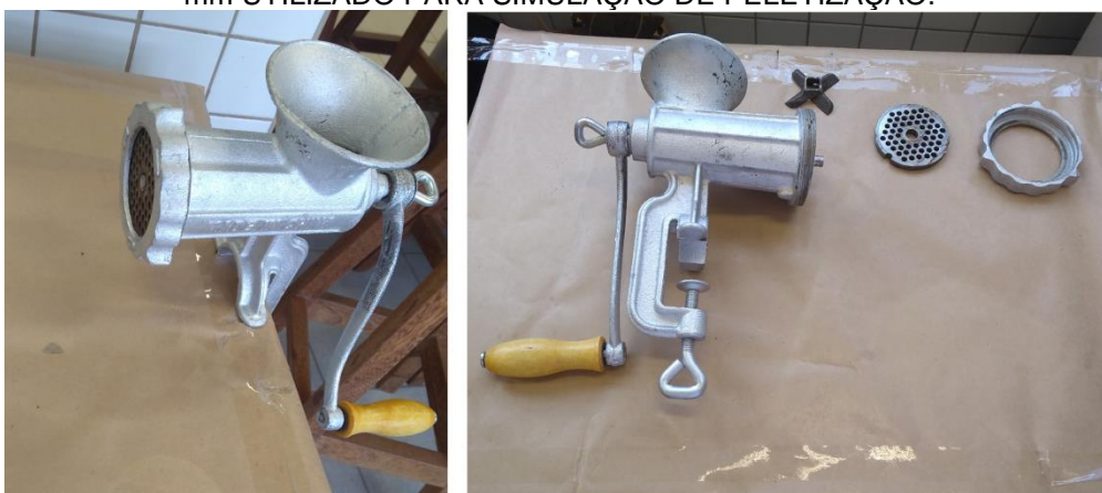
FIGURA 4 - MOEDOR DE CARNE DE BANCADA MANUAL N°10, COM ABERTURA DE MATRIZ DE 5 mm UTILIZADO PARA SIMULAÇÃO DE PELETIZAÇÃO.
