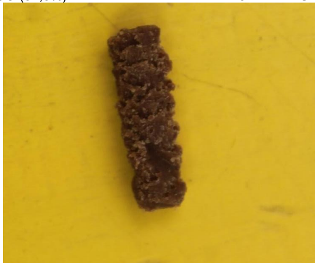
FIGURA 11 – VISÃO LATERAL DO PELLET FORMADO DE UMA ASSOCIAÇÃO AMIDO (24,8%) E COMPOSTO PROTEICO (51,3%) A PARTIR DA MATRIZ DE 5 mm DE UM MOEDOR DE BANCADA.
