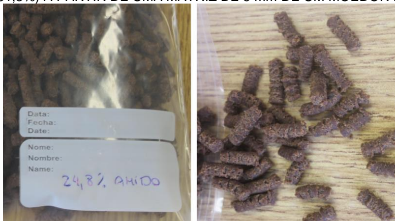
FIGURA 12 – PELLETS FORMADOS DE UMA ASSOCIAÇÃO AMIDO (24,8%) E COMPOSTO PROTEICO (51,3%) A PARTIR DE UMA MATRIZ DE 5 mm DE UM MOEDOR DE BANCADA.
