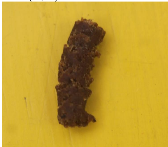
FIGURA 9 – VISÃO LATERAL DO PELLET FORMADOS DE UMA ASSOCIAÇÃO AMIDO (12,4%) E COMPOSTO PROTEICO (63,8%) A PARTIR DA MATRIZ DE 5 mm DE BANCADA.
