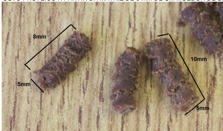
FIGURA 7 – TAMANHO APROXIMADO DOS PELLETS FORMADOS DE UMA ASSOCIAÇÃO DE AMIDO E COMPOSTO PROTEICO A PARTIR DA MATRIZ DE 5 mm DE UM MOEDOR DE BANCADA.
