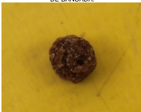
FIGURA 10 – VISÃO DO CORTE LONGITUDINAL DO PELLETT FORMADO DE UMA ASSOCIAÇÃO AMIDO (24,8%) E COMPOSTO PROTEICO (51,3%) A PARTIR DA MATRIZ DE 5 mm DE UM MOEDOR DE BANCADA.
