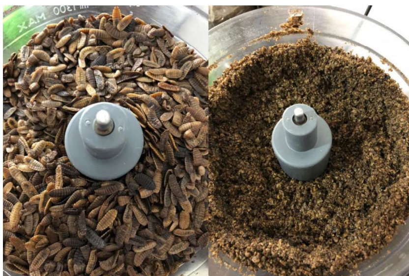
Figura 6 - Processo de fabricação da farinha de larva de mosca soldado negro. Fonte: Autora (2022).
