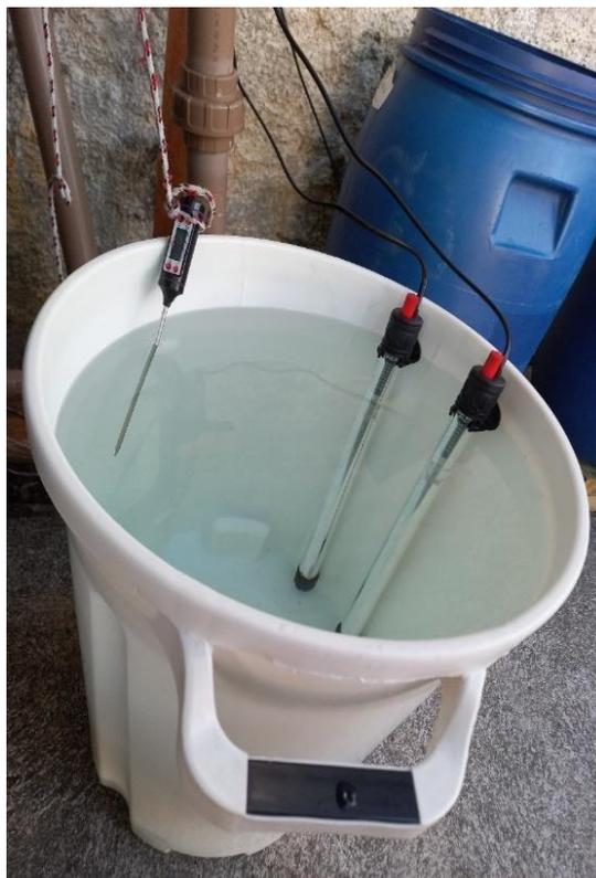
*Figura 22 - TESTE DE FUNCIONAMENTO DOS AQUECEDORES*
