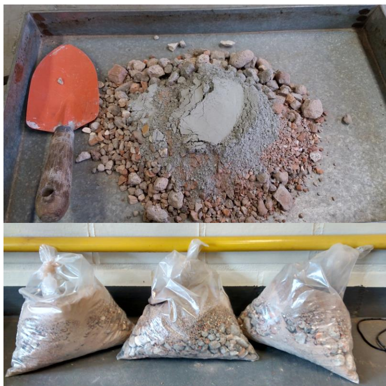
Figura 2 – Amostra de RCC com adição de cimento Portland. Fonte: próprios autores (2017).
