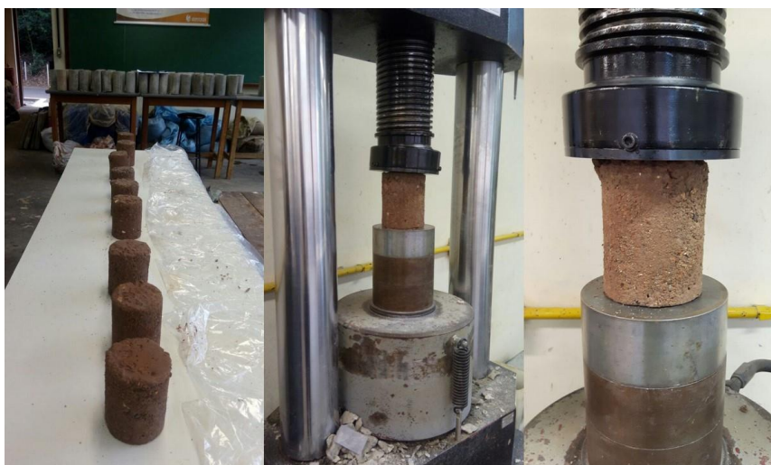
Figura 6 1– Ensaio de RCS após cura de 7 dias. Fonte: próprios autores (2017).
