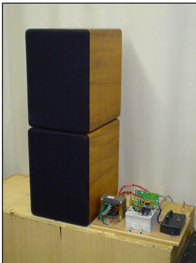
Figura 6.1. Fotografia das caixas fechadas e dos amplificadores de tensão e corrente montados para este trabalho.
