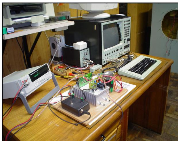
Figura 6.6. Foto dos amplificadores de tensão e corrente ao lado do analisador B&K modelo 2012 (ao fundo) utilizado nos testes.
