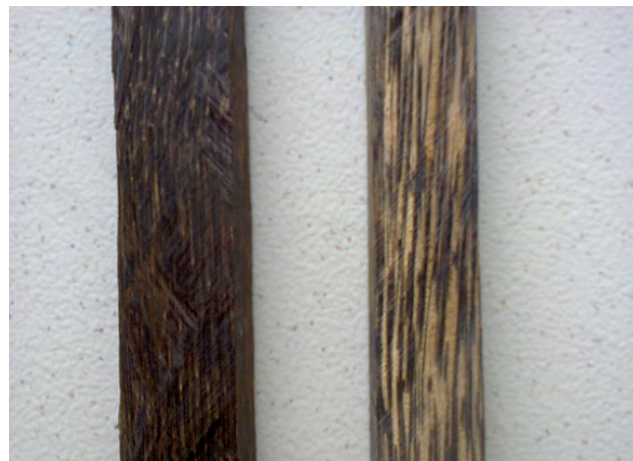
Figura 04: Amostras extras, vista da parte periférica após a casca (à esquerda) e da parte periférica iniciando transição com a medula (à direita)
