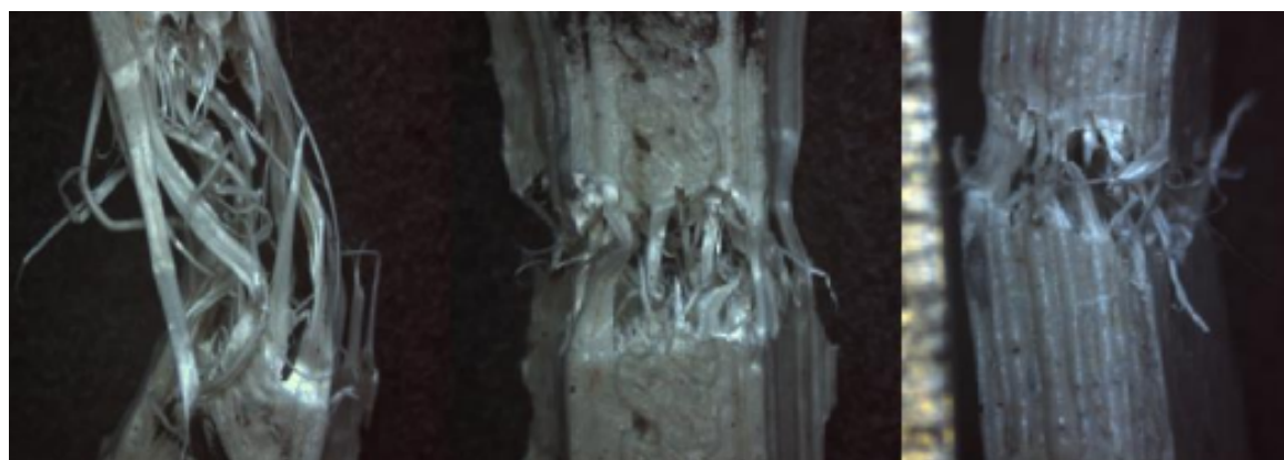
Figura 5: Corpos de prova PPR 4 e PPR1 rompidos. Fonte: Autores.
