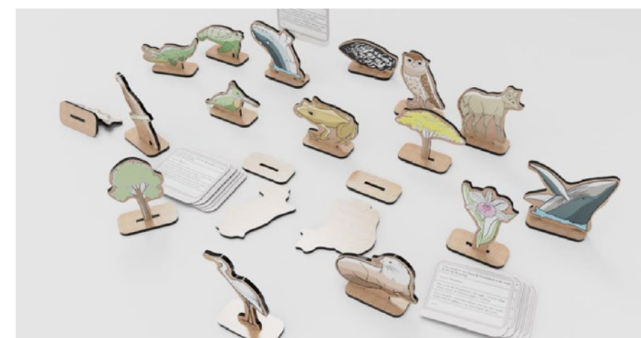
Figura 5: Peças de cada elemento montadas com corte a laser. Fonte: elaborado pelos autores.
