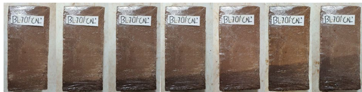
Figura 2: Sequência fotográfica do processo de ascensão capilar da água no adobe. Fonte: Autoras
