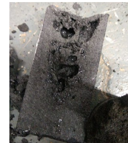
Figura 02: CP com vazios. Fonte: Autoria própria (2022).
