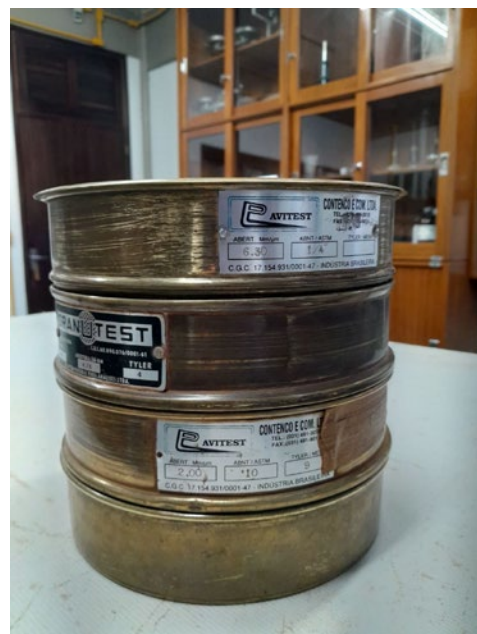
Figura 2: Sequência de peneiras utilizadas para realizar a granulometria do vidro moído.
