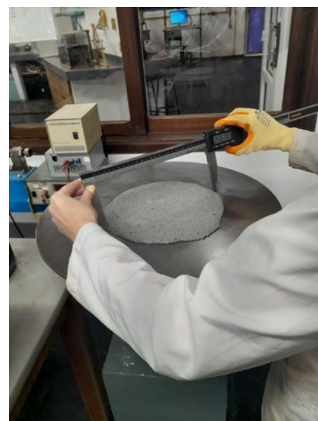
Figura 4: Ensaio na mesa Mesa de Consistência.
