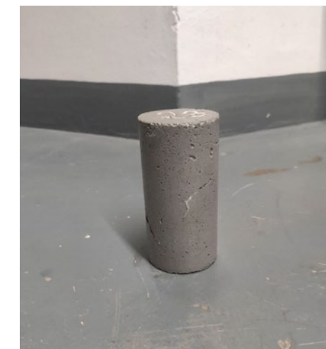
Figura 9: Corpo de prova do traço com 45% de vidro antes de ser rompido aos 28 dias.
