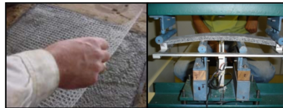
Figura 7.a: Moldagem da placa cimentícia com partículas de borracha. Fonte: Rodrigues, 2008.
