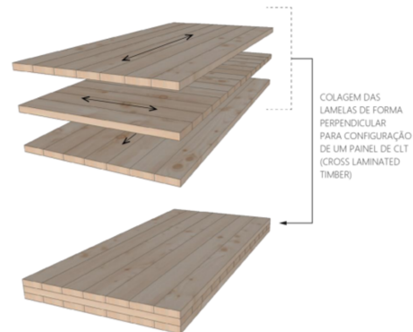
Figura 1: Representação de painel CLT. Fonte: Oliveira (2018).
