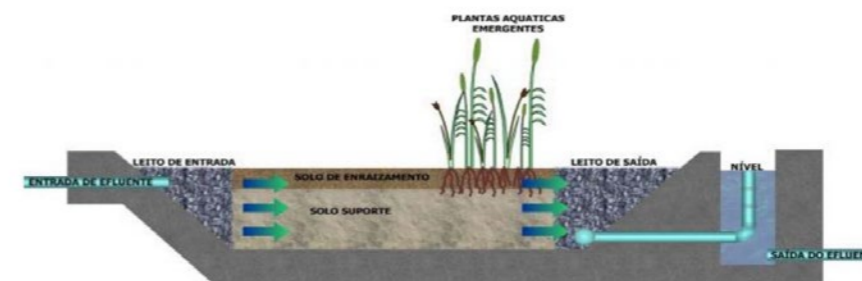
Figura 07 - Sistema de Fluxo Horizontal subsuperficial. Ecocell, Pelotas (2003).
