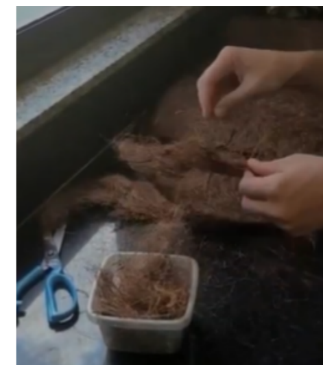
Figura 2: Preparação da fibra de coco. Fonte: elaborado pelos autores.
