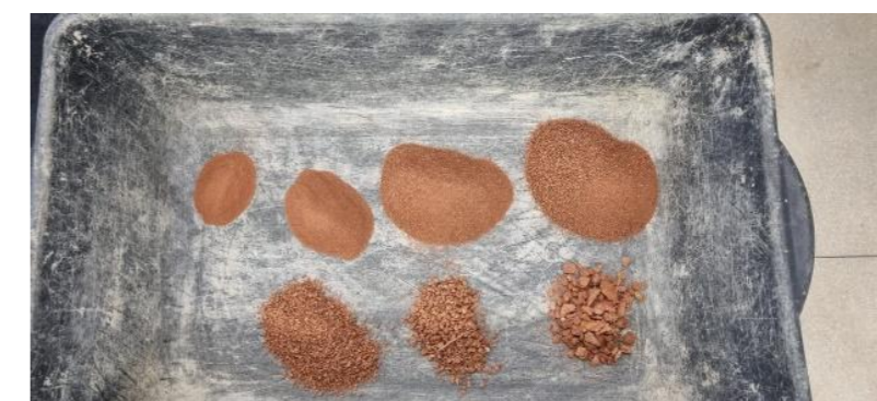
Figura 3: Resultado do ensaio de granulometria da terra. Fonte: elaborado pelos autores.
