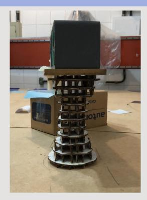
Primeiro teste para a materialização dos pilares com a técnica de **interlocking** no software Slicer feita a partir de **papelão** cortado a **laser**
