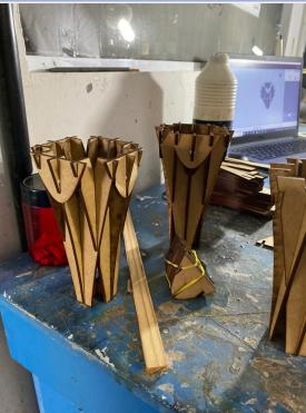
Após testes com papelão, foram cortadas as placas de mdf 3mm para os pilares
