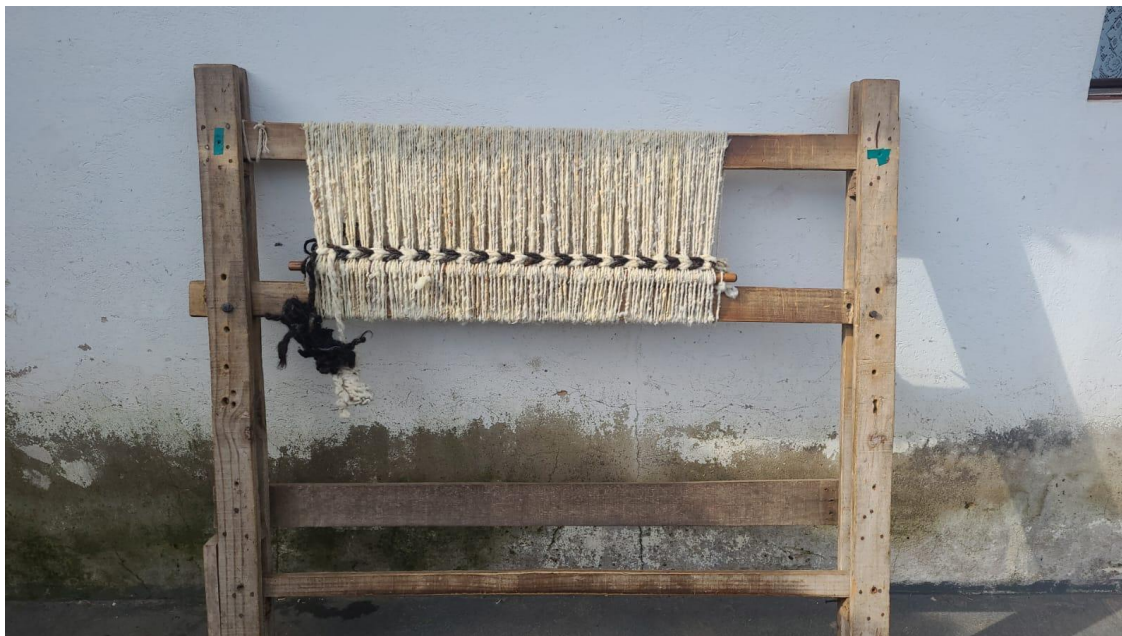
Imagem 6 - Estrutura do tear com fios de urdidura na vertical. Foto cedida por Marcelo.
