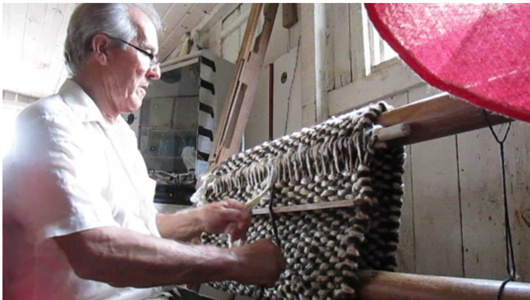
Imagem 3 - Tear Vertical Neri, onde se pode ver os orifícios nas traves verticais. Foto: Raquel
