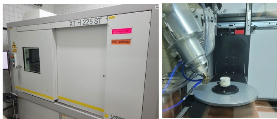
Figura 11: Esq. Industrial CT Scanning - XT H 225 ST. Dir. Vista interna do XT H 225 ST com amostra do Citrus. Fonte: elaborado pelos autores em colaboração com DEN.
