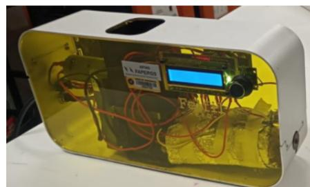
Figura 2: Extrusora utilizada para produção dos filamentos. Fonte: Autores.
