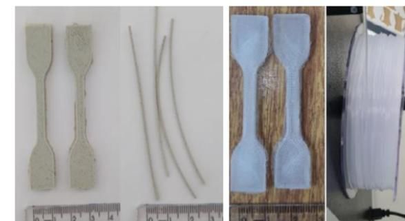
Figura 4: Corpos de prova e filamento de PP reciclado e PP comercial. Fonte: Autores.
