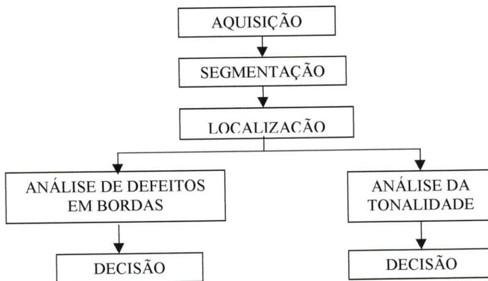
Fig. 4.2 Diagrama em blocos do sistema de análise e classificação de peças cerâmicas
