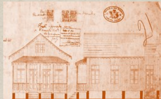
Figura 40 – Projeto de 1913. Exemplo de construção de madeira com sótão e lambrequins
