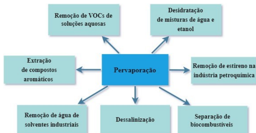
Figura 11 - Exemplo de aplicação do processo de PV para separação de misturas.
