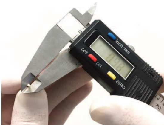
Fig. 10. Área transversal das barras sendo mensurada com paquímetro digital.
