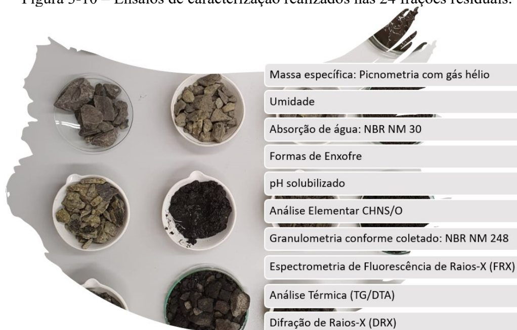
Figura 3-10 – Ensaio de caracterização realizados nas 24 frações residuais.
