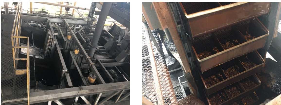
Figura 2-7 – Jigue (a esquerda) seguindo a direita pelo elevador de canecos por onde sai o rejeito na concentração de carvão de uma mineradora do sul de Santa Catarina.
