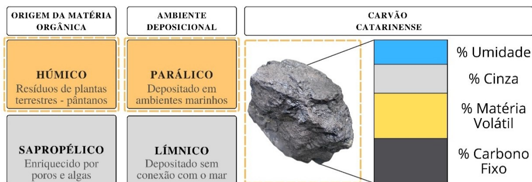
Figura 2-2 – Classificação do carvão quanto a origem da matéria orgânica, ambiente deposicional relacionando com a composição de carvão retirada do ROM de uma mineração do sul de Santa Catarina.
