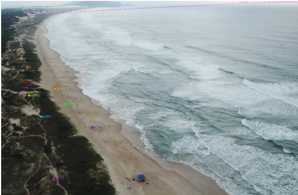
Figura 12. Exemplo do georreferenciamento das imagens, cruzes coloridas, pontos selecionados na imagem e círculos vermelhos representam as coordenadas no mundo real.
