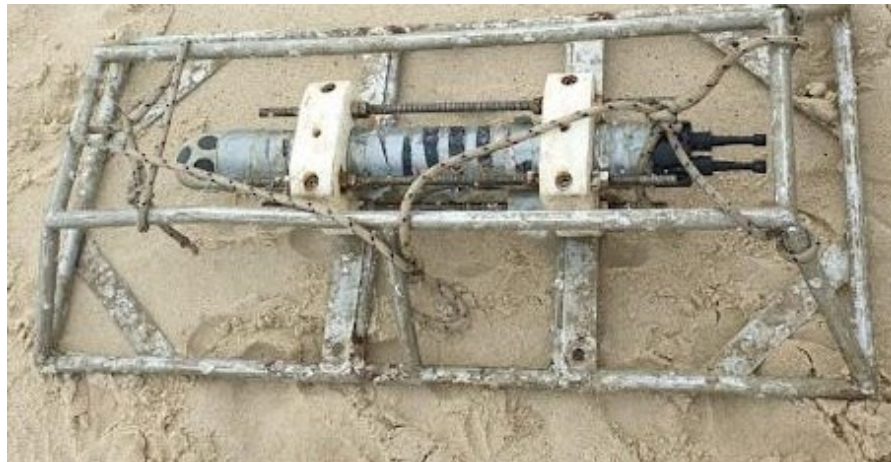
Figura 7. Perfilador Acústico tipo Doppler da Nortek modelo Aquadopp 1MHz, utilizado em campo
