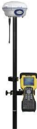
Figura 5. Receptor GNSS RTK utilizado para a coleta de pontos de controle.
