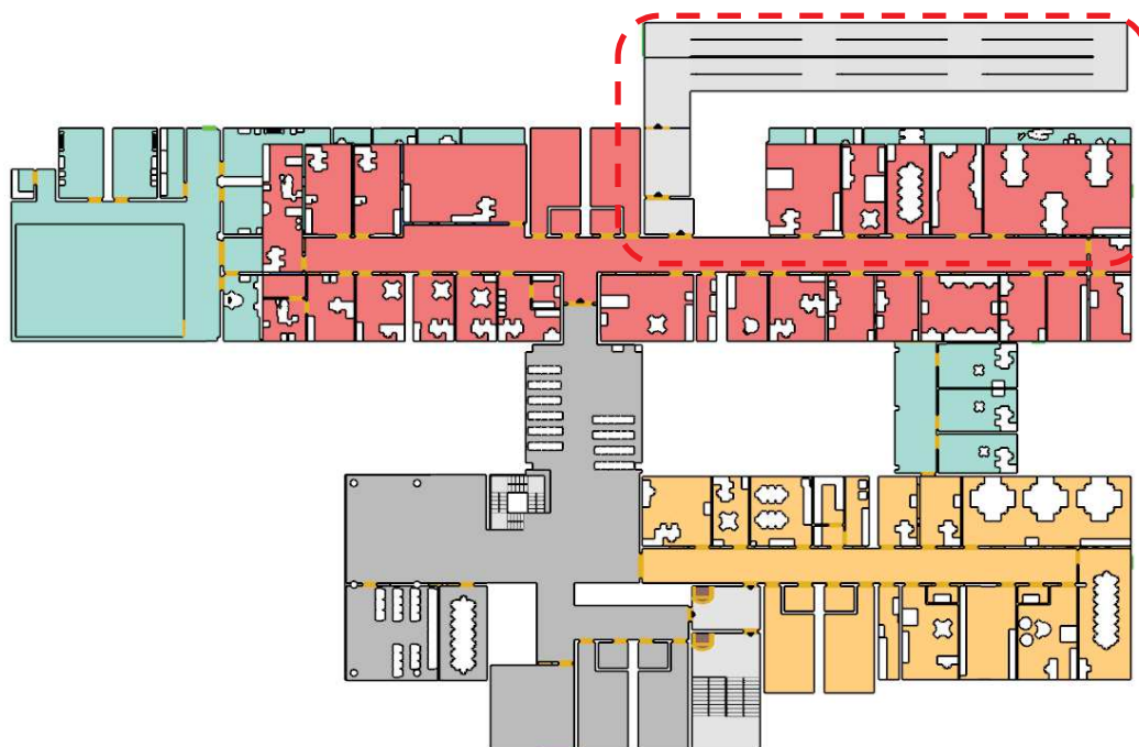
Figura 12 – Sobreposição de plantas baixas indicando inserção de rampa externa para evacuação em substituição à escada 01
