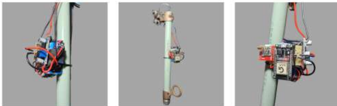
Figura 30 – Protótipo montado e acoplado no cartucho da chave-fusível
