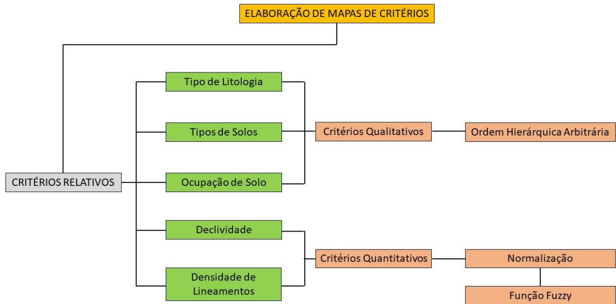
Figura 5. Fluxograma da elaboração do mapa de critérios para delinear zonas potenciais de águas subterrâneas utilizando técnicas de Sensoriamento Remoto, SIG e metodologia AHP.
