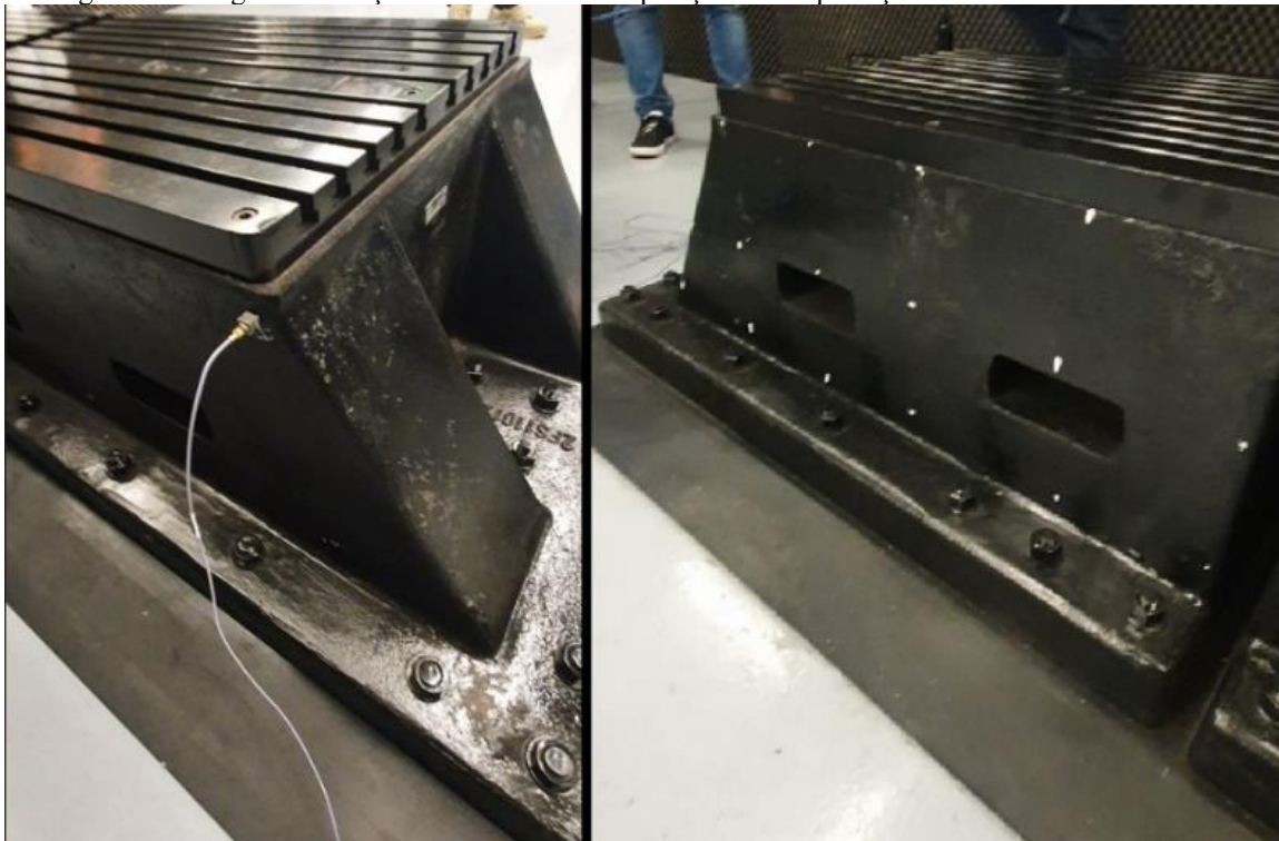
Figura 52 – Região de fixação do acelerômetro e posições de impactação do martelo instrumentado
