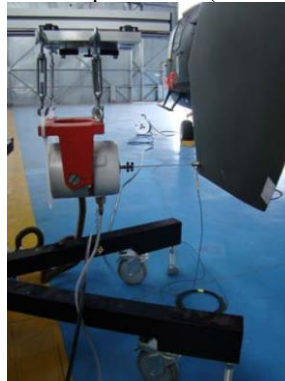
Figura 39 – Montagem do experimento (análise modal experimental)
