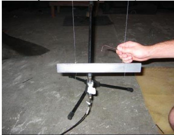
Figura 36 – Análise modal experimental em chapa da carcaça de um compressor hermético
