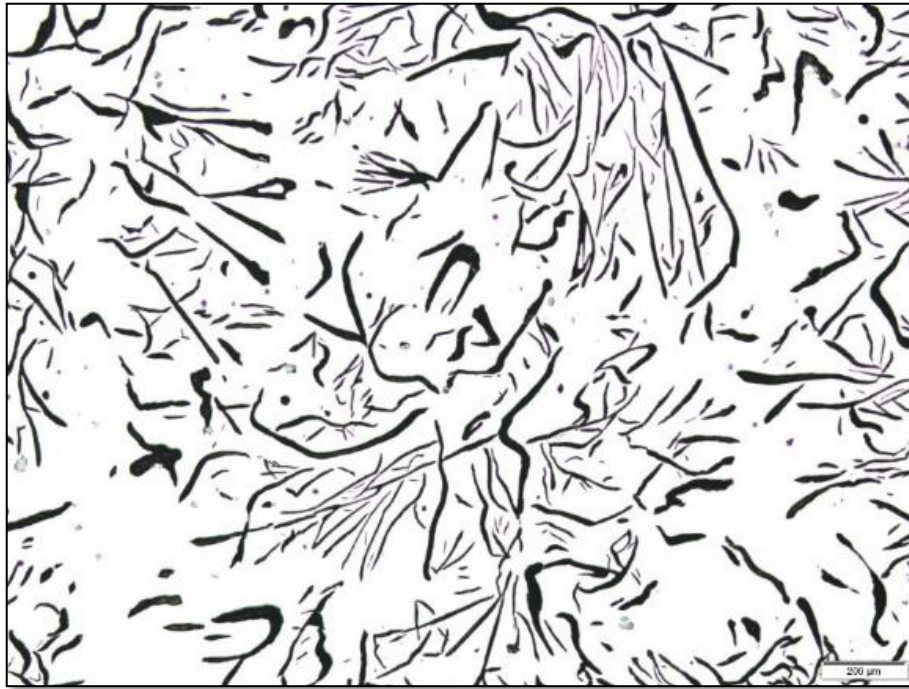
Figura 49 – Metalografia – Ferro Fundido Cinzento
