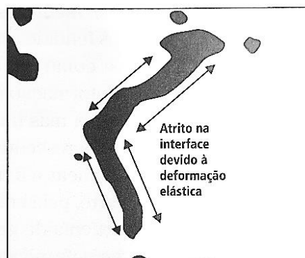
Figura 32 – O amortecimento das tensões vibracionais ocorre devido ao atrito entre as partículas de grafita e a matriz metálica
