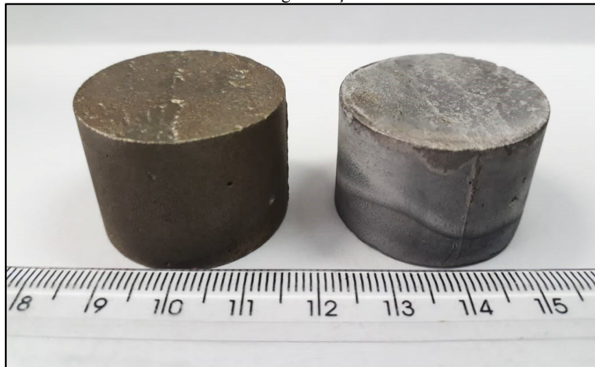
Figura 29: Aspecto superficial da liga à base de Sm-Fe antes (esquerda) e após (direita) o tratamento térmico de homogeneização.
