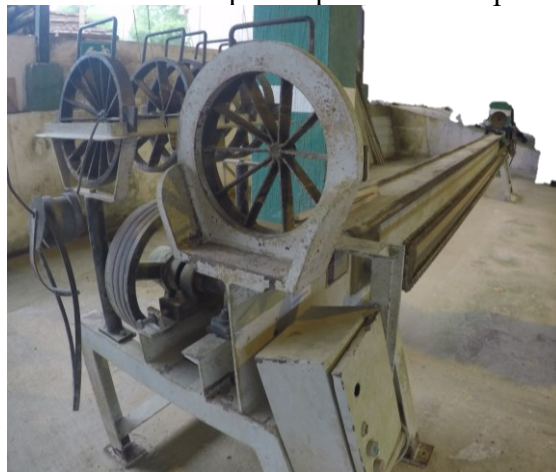
Figura 25 – Alternativa industrial para o processo de ripar um colmo de bambu.
