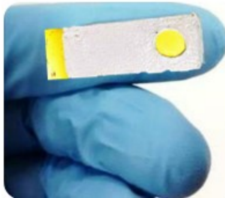
Figura 3.2 O eletrodo de trabalho de Au do aptasensor impedimétrico e sua respectiva máscara.
