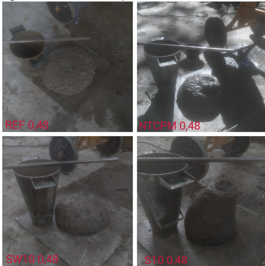
Figura 30 – Fotos dos concretos produzidos REF, MWCNT, SW10 e S10
