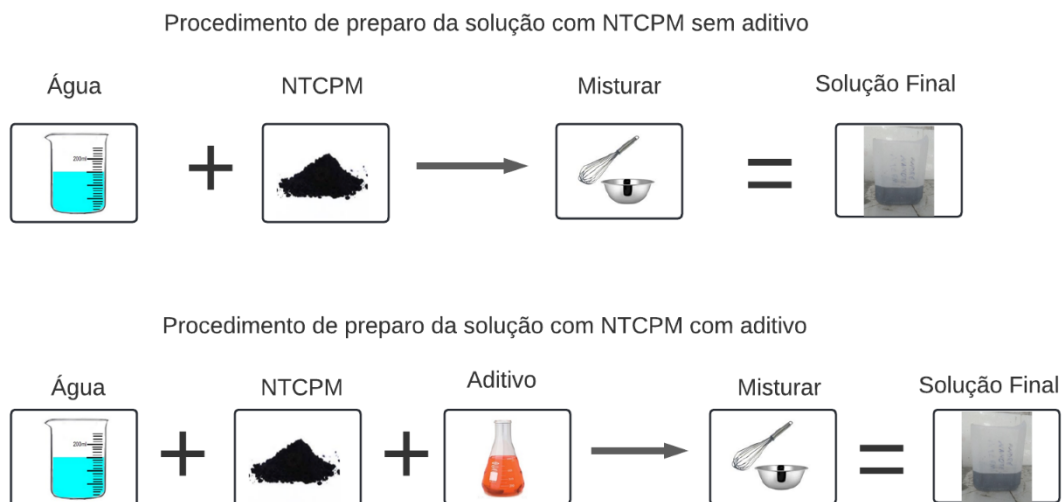
Figura 13 – Preparo das soluções aquosas com NTCPM
