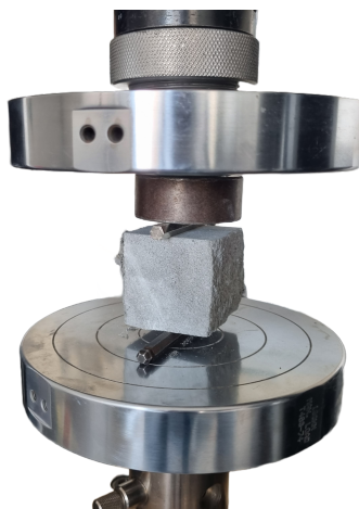
Figura 34 – Ensaio de aderência intercamadas.
