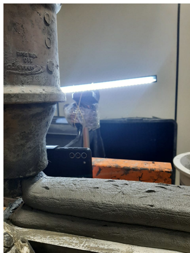
Figura 27 – Posicionamento da câmera para o teste de estabilidade de forma.
