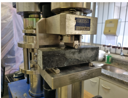
Figura 36 – Ensaio de resistência à tração na flexão - amostra moldada.
