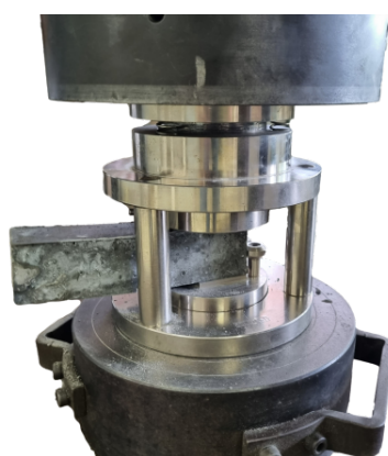
Figura 37 – Ensaio de resistência à compressão axial - amostra moldada.
