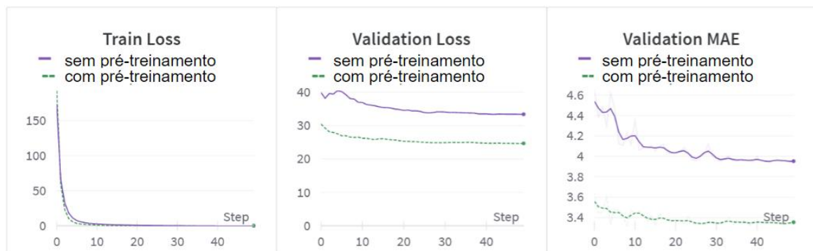
Figura 33 – Comparação entre um modelo ResNet50 com inicialização de pesos pré-treinados na ImageNet e um modelo com inicialização de pesos aleatórios
