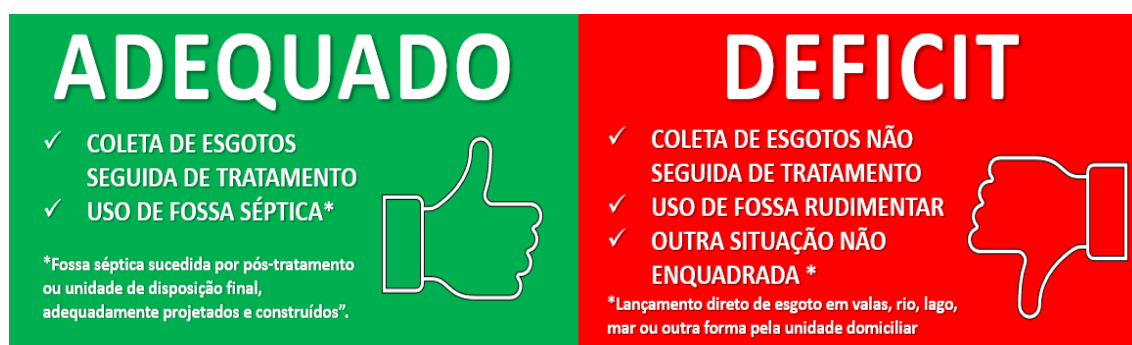
Figura 2: Desenho esquemático dos conceitos do PLANSAB de situações adequadas e do déficit de esgotamento sanitário.
