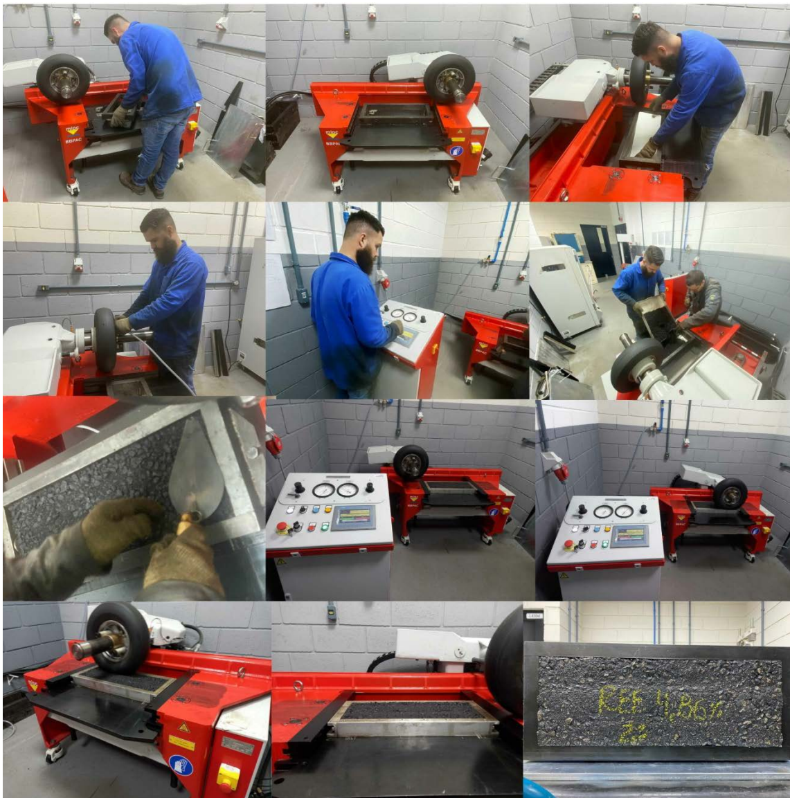
Figura 5.14 – Compactação das placas para o ensaio de deformação permanente.
