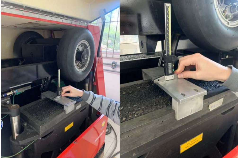
Figura 5.17 – Leitura dos afundamentos com o paquímetro.
