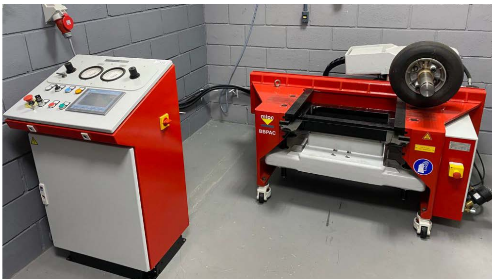
Figura 5.13 – Máquina para compactação das placas.
