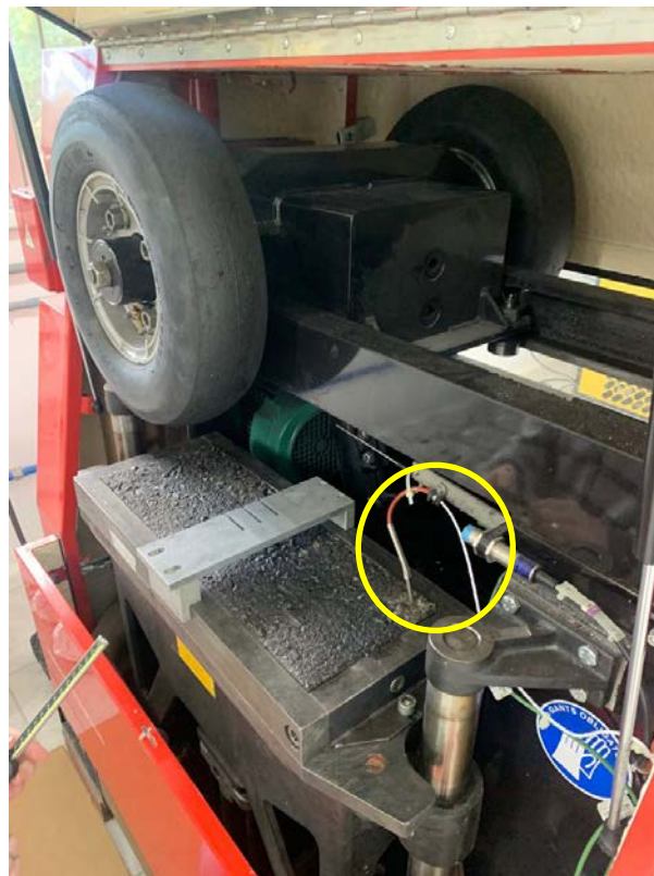
Figura 5.16 – Placa posicionada na máquina com a sonda de monitoramento de temperatura.
