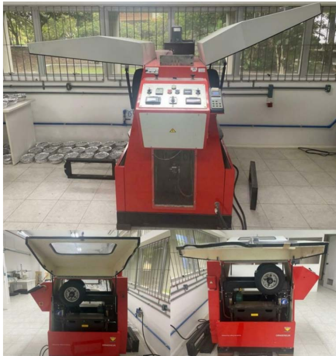
Figura 5.15 – Máquina para avaliação da deformação permanente (LabPav – UFSC/Florianópolis).
