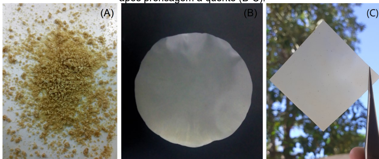
Figura 11: Granulometria dos materiais após moagem (A) e aparência dos filmes após prensagem a quente (B-C).
