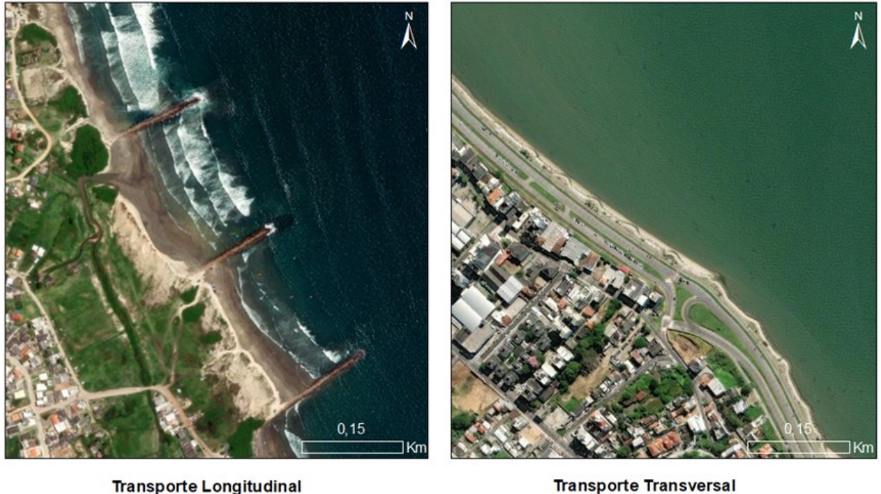
Figura 4 - Incidência do transporte longitudinal em um campo de espigões no município de Imbituba e do transporte transversal em um enrocamento, localizado em Florianópolis
