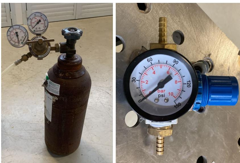
Figura 16 – Botijão de argônio à esquerda e regulador de pressão à direita
