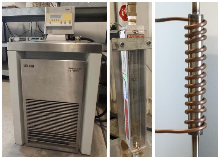
Figura 27 – LAUDA à esquerda, rotâmetro ao centro e serpentina à direita
