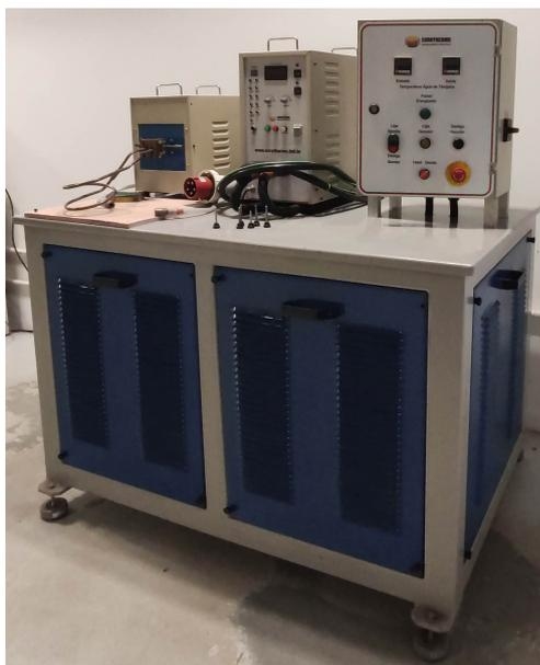
Figura 26 – Forno de indução EURO 25 kW da Eurothermo
