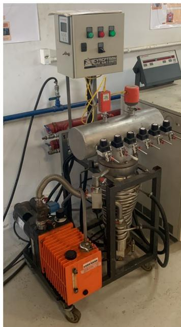
Figura 11 – Bomba difusora de alto vácuo
