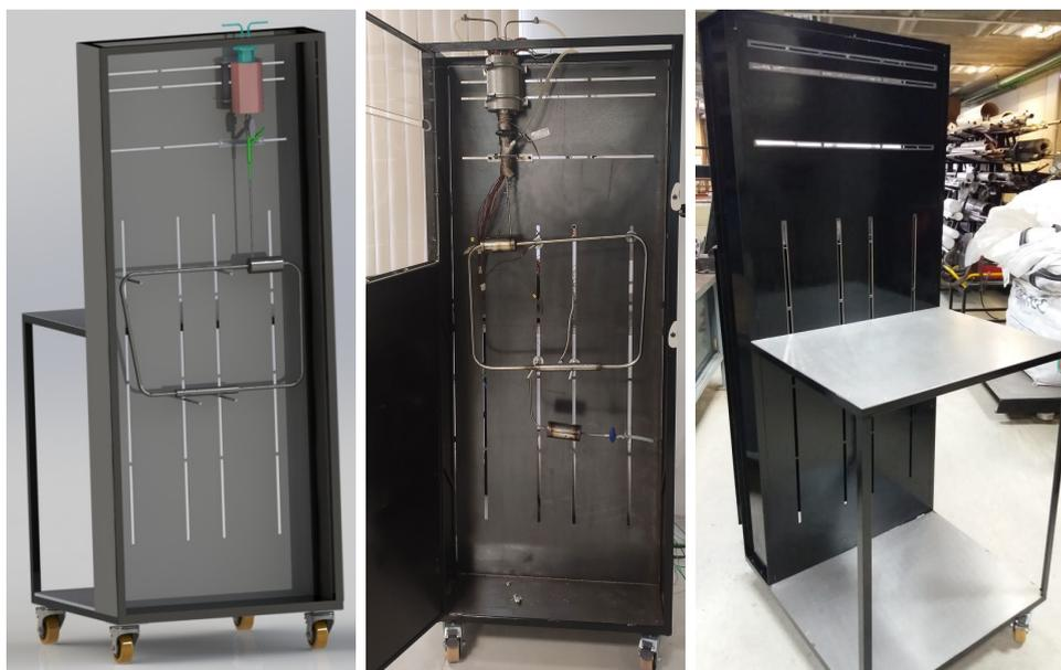
Figura 13 – Projeto (esquerda) e execução da bancada de carregamento de sódio (centro e direita)
