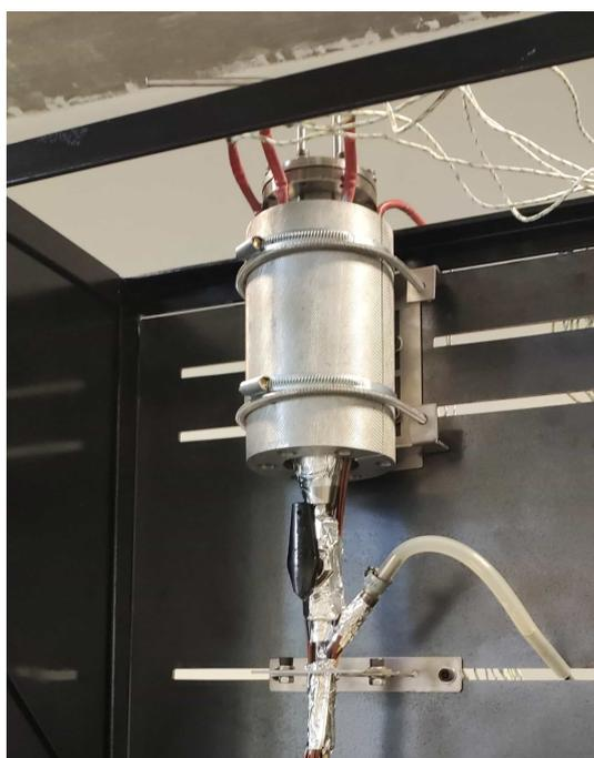
**Limpeza do termossifão:** a limpeza do termossifão precisa ser realizada previamente à sua fixação na bancada de carregamento.
