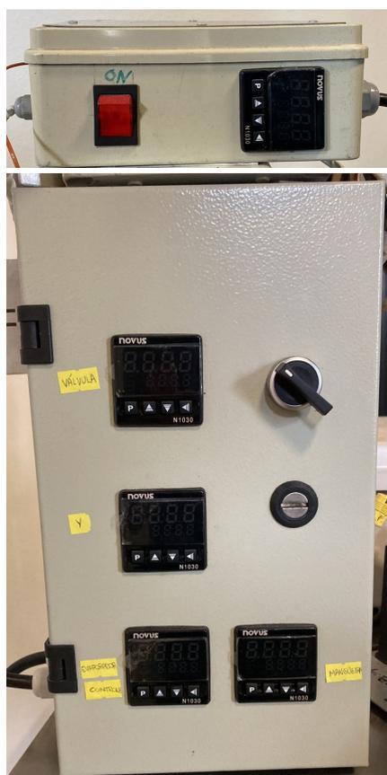
Figura 19 – Controladores PID das resistências de cartucho (acima) e de fita (abaixo)
