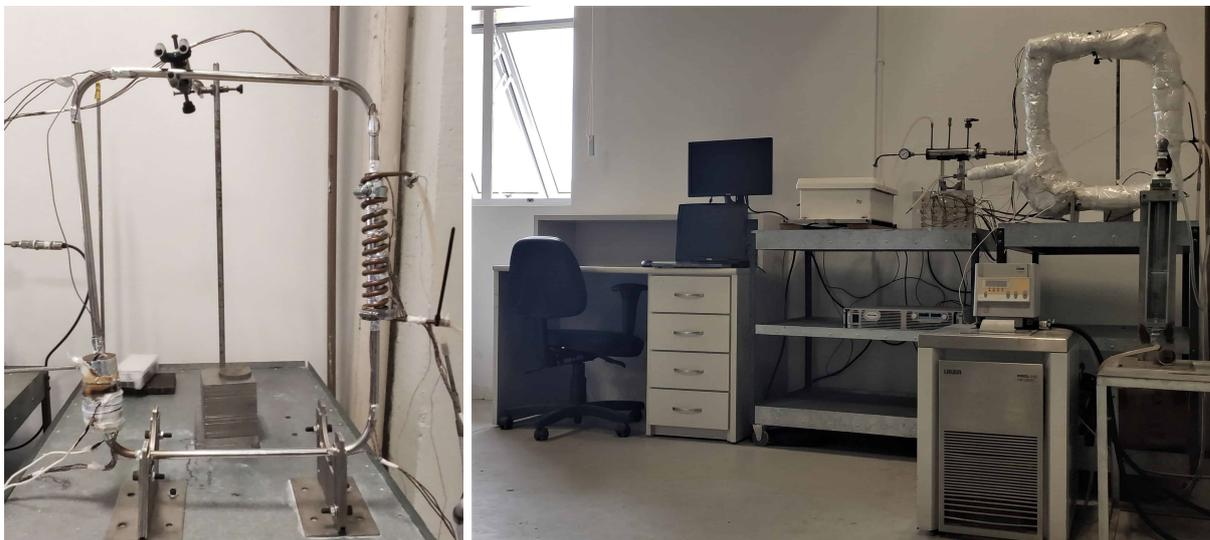
Figura 31 – Circuito 1 sem isolamento (esquerda) e sua bancada experimental para a água (direita)
