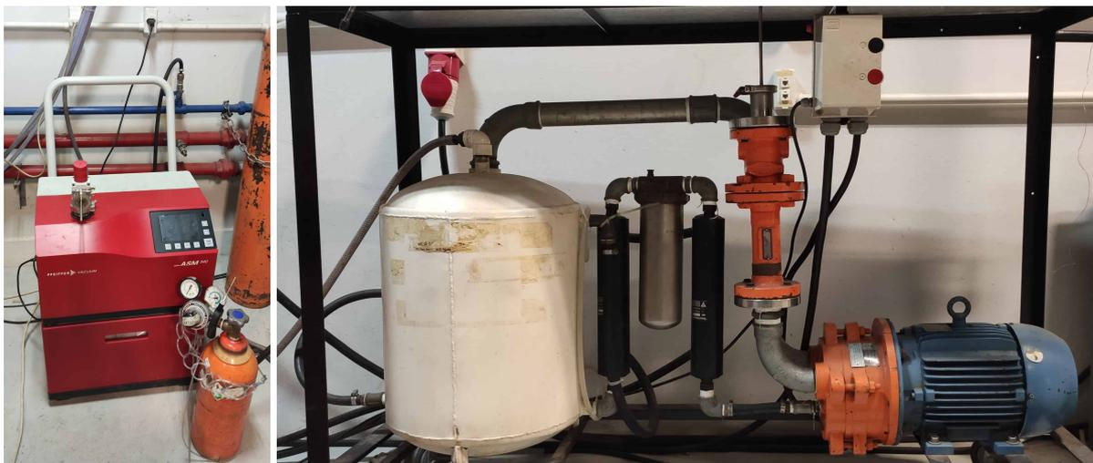
Figura 10 – *Leak Detector* à esquerda e bomba de anel líquido à direita
