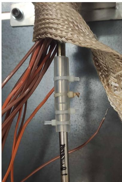
Figura 20 – Conexão do termossifão com o tubo em Y
