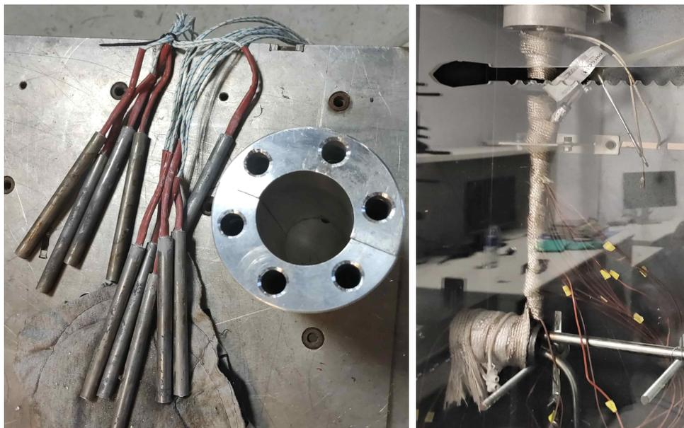
Figura 18 – Resistências de cartucho (esquerda) e de fita (direita) para aquecimento da bancada de carregamento
