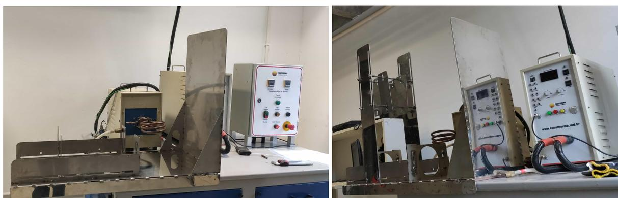
Figura 34 – Diferentes vistas do suporte fabricado de fixação dos termossifões no forno de indução
