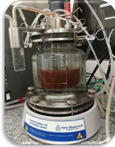
Figura 8 - Biorreator New Brunswick BioFlo 115 de 1,5 L alimentado com o hidrolisado hemicelulósico do resíduo de acerola durante o processo fermentativo.
