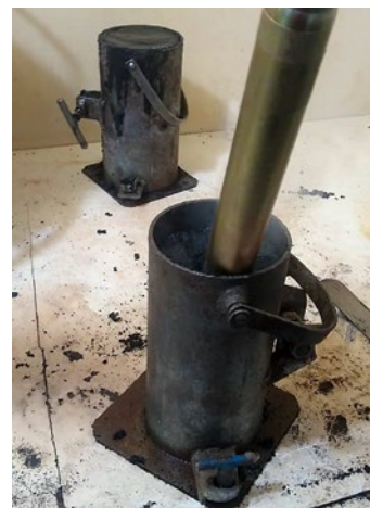
Figura 04: Vibrando o compósito. Fonte: Autoria própria (2022).
