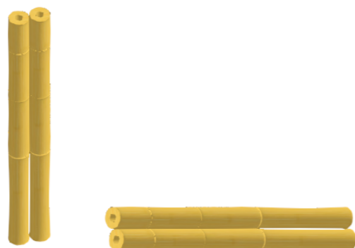
Figura 5: Pilar (a) e viga (b) com colmos duplos. Fonte: elaborado pelos autores.
