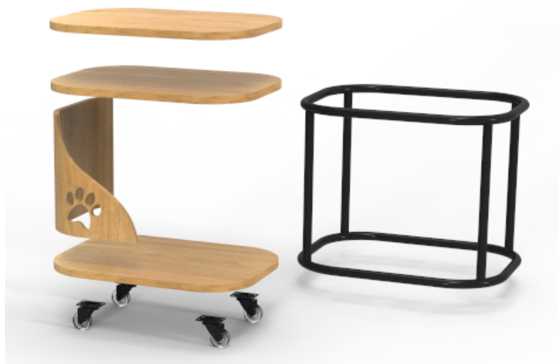
Figura 83 – Vista Explodida da Mesa de apoio/espaco pet
