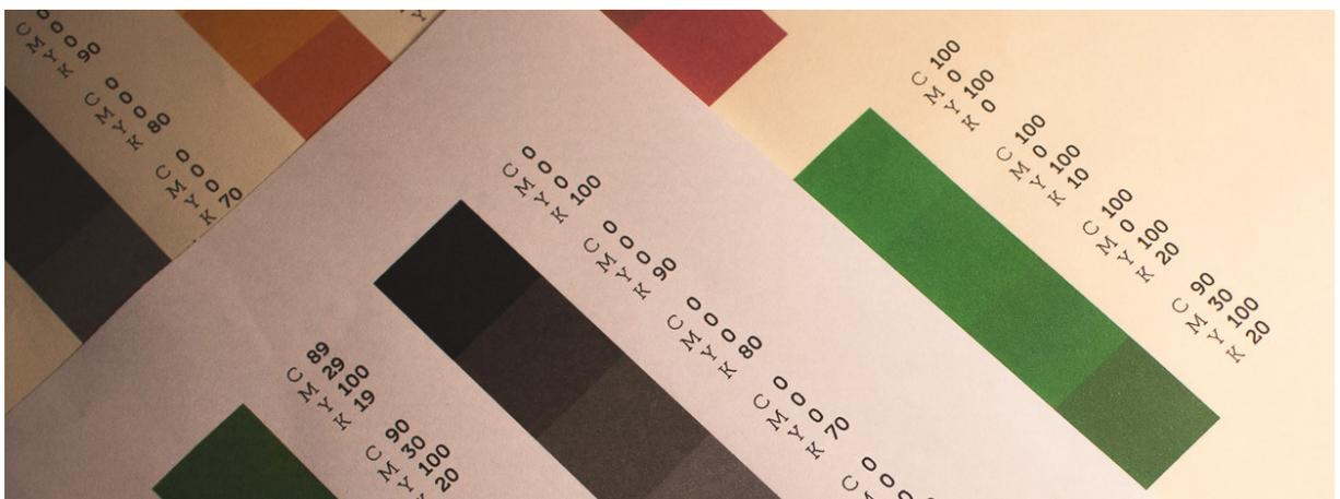
Figura 23 - Testes de impressão de cores.
