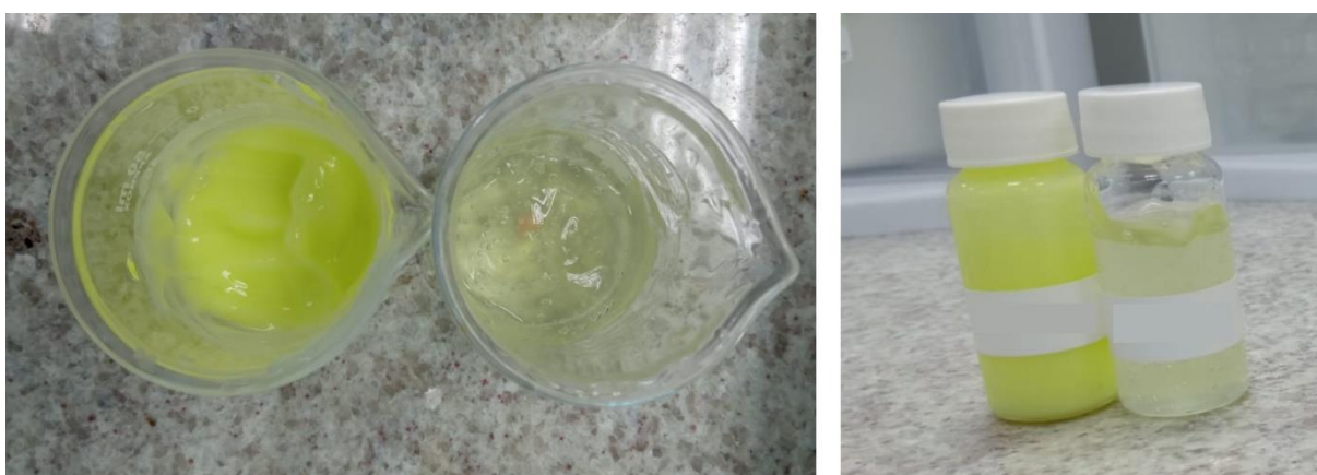
Figura 10. Resultado da incorporação do ativo livre (à esquerda das imagens) e nanoencapsulado (à direita das imagens). Fonte: da autora, disponibilizada com autorização pela Nanovetores, 2023.
