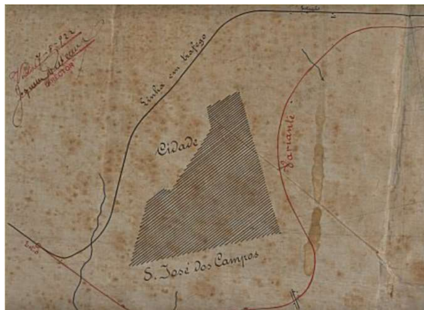
Figura 8. Mapa da Central do Brasil de 1922, mostrando a linha antiga (linha em tráfego) e a linha nova em construção (variante)
