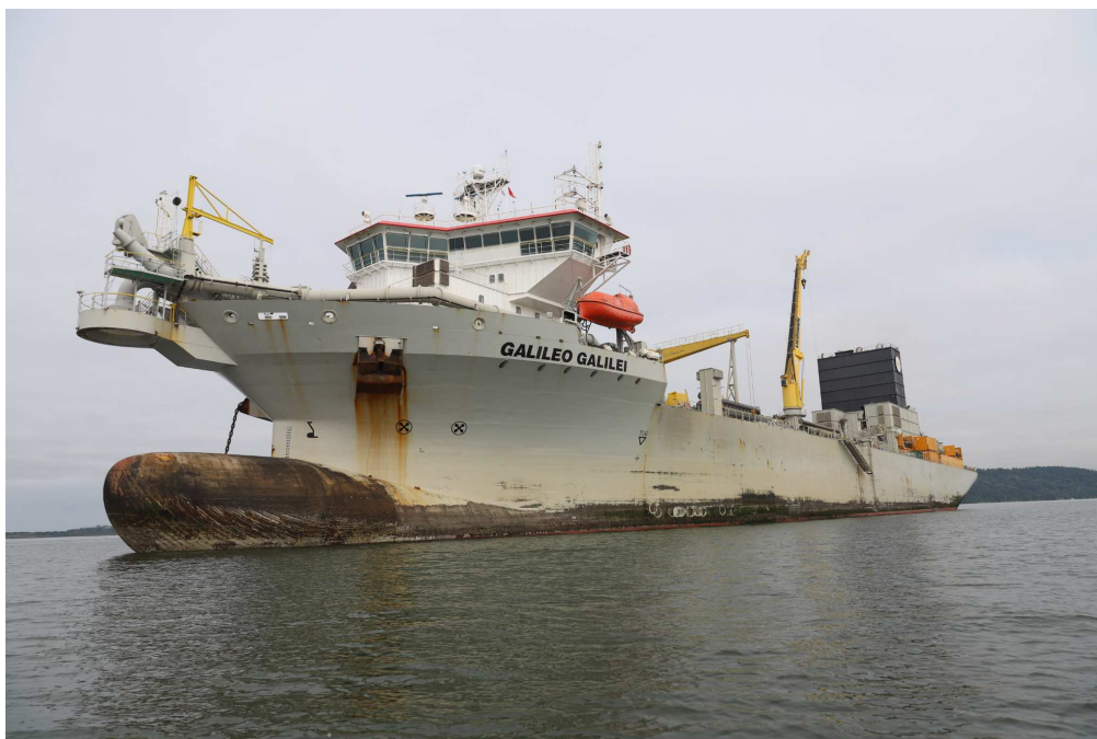
Figura 47 - Draga de sucção e recalque, Navio Galileo Galilei
