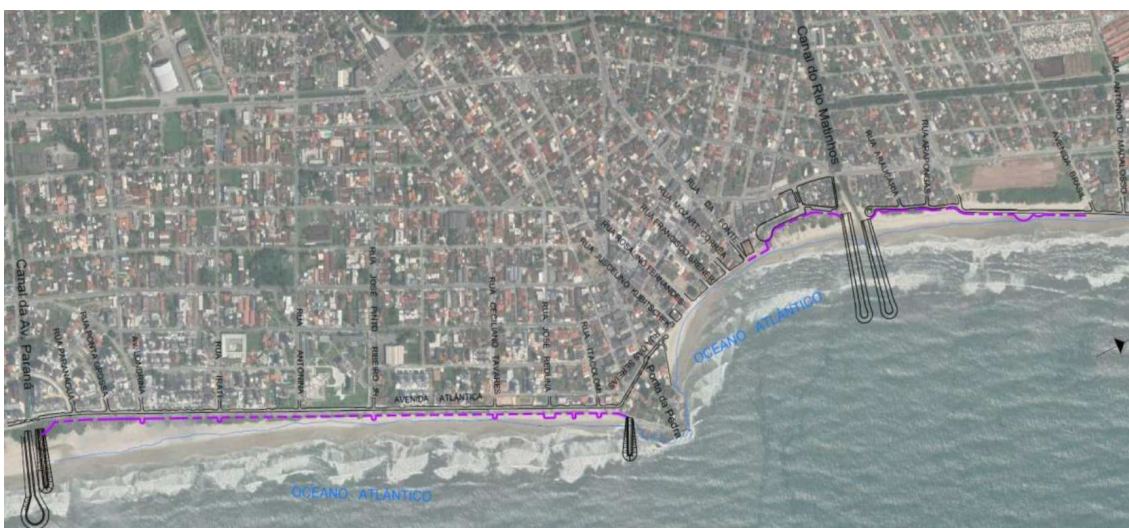
Figura 50 - Trechos atendidos pela obra de proteção costeira
