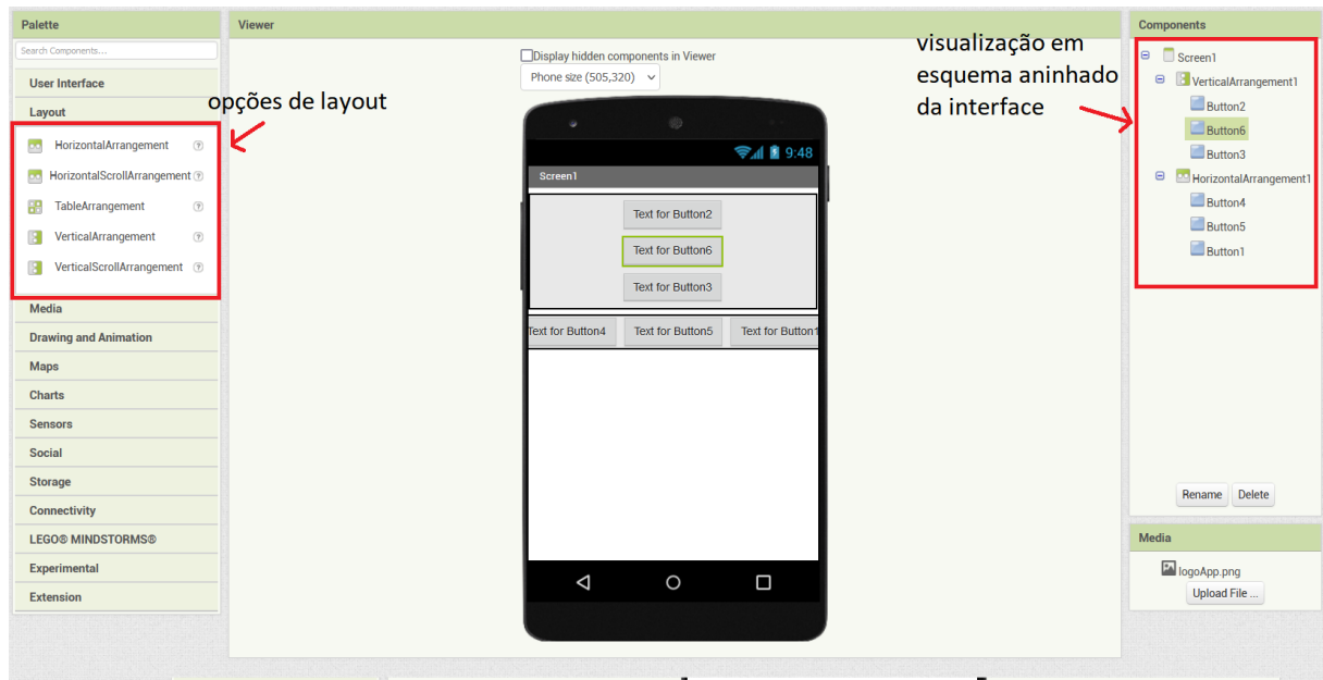
Figura 10. Elementos de alinhamento, sua visualização na interface e no esquema. (Fonte: próprio autor).
