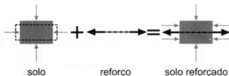
Figura 2- Princípio de funcionamento do solo reforçado
