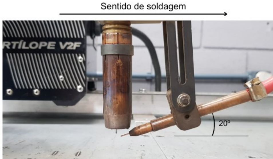
Figura 22 – Posicionamento de inserção do arame adicional
