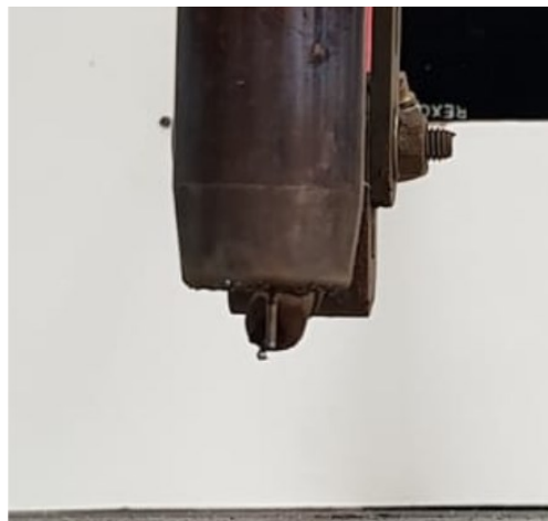
Figura 27 – Vista frontal da inserção do arame frio
