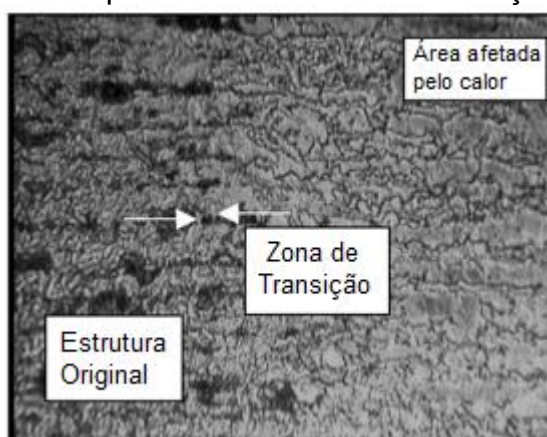
Figura 25 – A área afetada pelo calor e a zona de transição do corte da amostra
