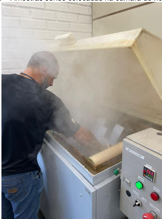
Figura 20 – Amostras sendo colocadas na câmara de névoa salina
