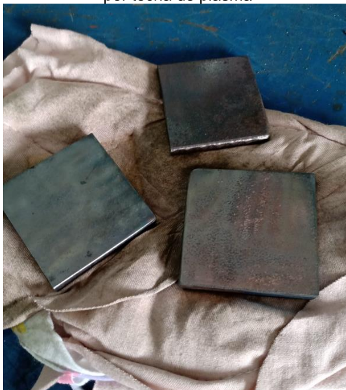
Figura 23 – Imagem da superfície das amostras após o tratamento de jateamento por tocha de plasma
