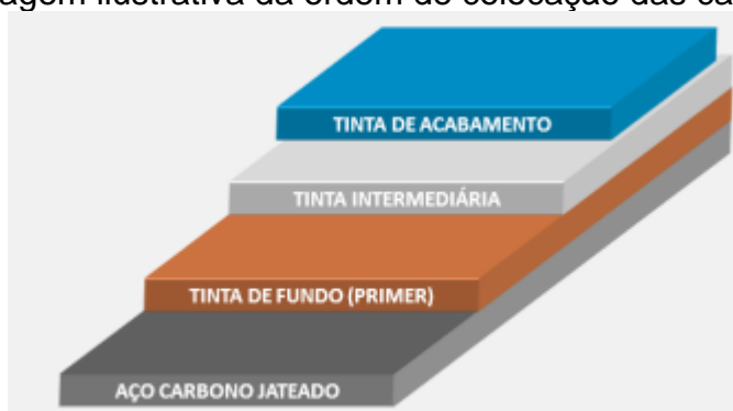
Figura 3 – Imagem ilustrativa da ordem de colocação das camadas de tinta
