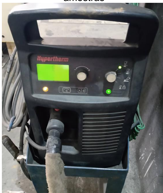
Figura 15 – Imagem ilustrativa da fonte de plasma utilizada no tratamento das amostras
