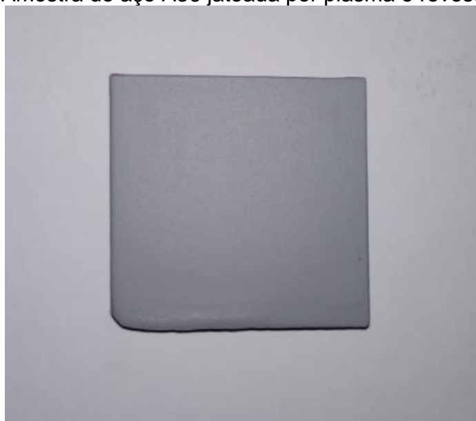
Figura 26 – Amostra de aço A36 jateada por plasma e revestida com tinta
